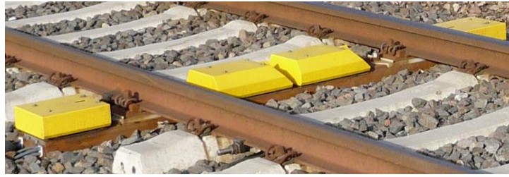
Рисунок 4.5 – Підлогові сканери температури
