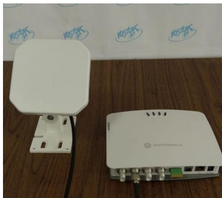
Рисунок 4.3 - RFID – зчитувач (антена АН 480 та контролер FX7400)
