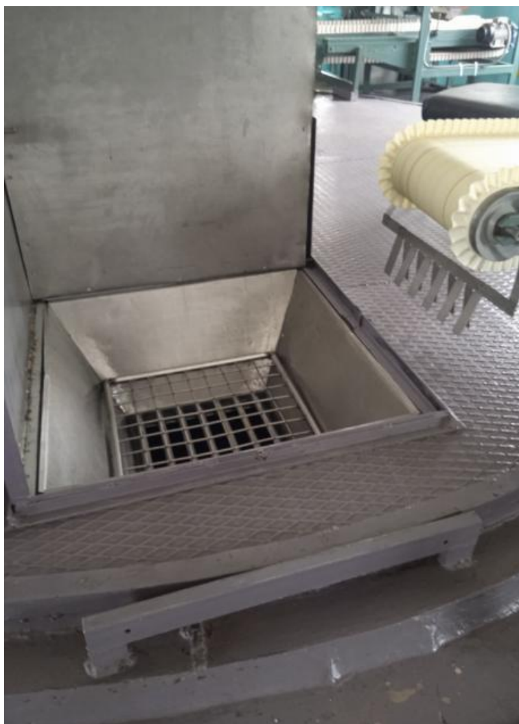
Рисунок 4.12 – Решітка з магнітним загороджувачем
