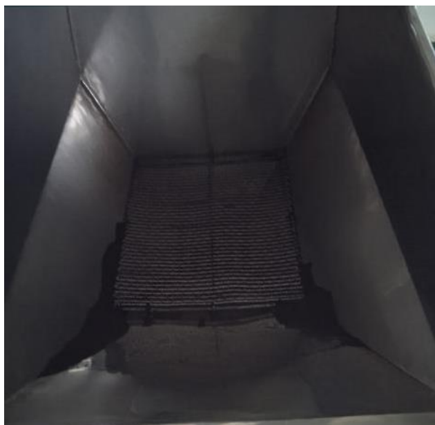
Рисунок 4.16 – Засипна горловина бункера
