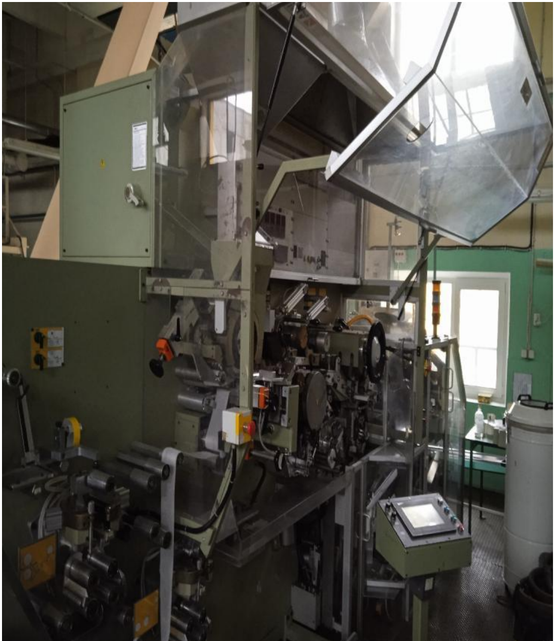
Рисунок 4.24 – Автоматизована фасувальна лінія ІМА 2000
