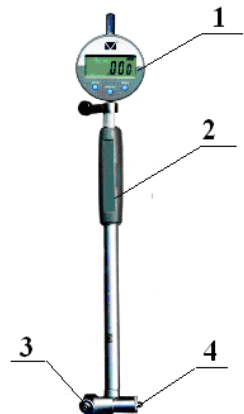
1 – цифровий відліковий пристрій; 2 - ручка; 3 - нерухомий вимірювальний стрижень; 4 - центруючий мостик
