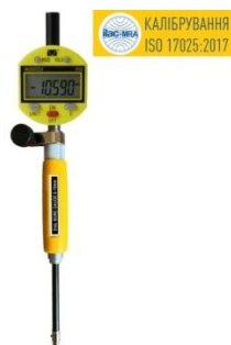
Рисунок 1.8 - Нутромір індикаторний цифровий
