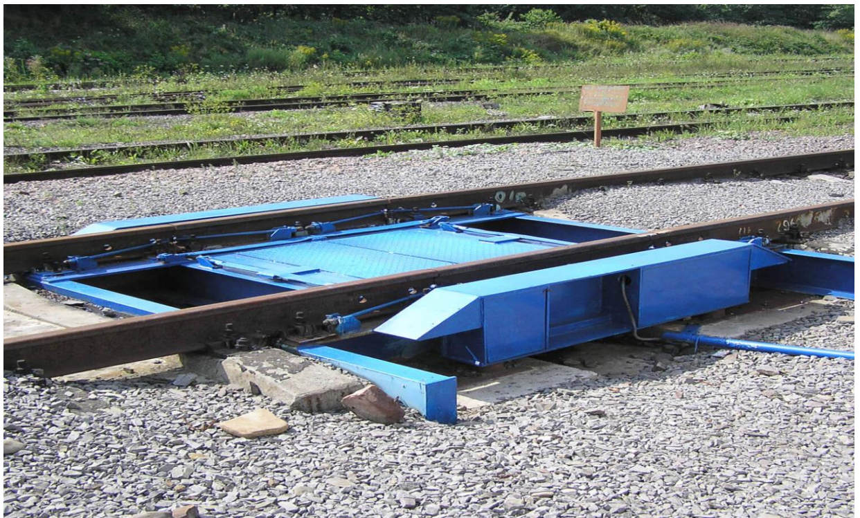
Рисунок 3.1 - Вагонні ваги повізкового зважування під час руху складаються з однієї ваговимірювальної платформи
