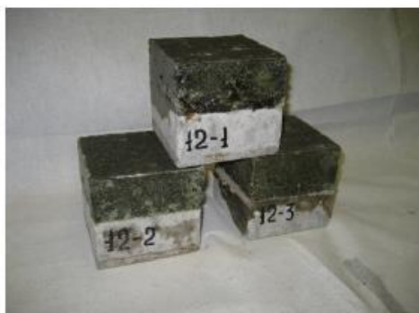
Рис. 2. Комбіновані зразки для оцінки адгезійних властивостей високонаповнених ПКМ на основі акрилового композиту
