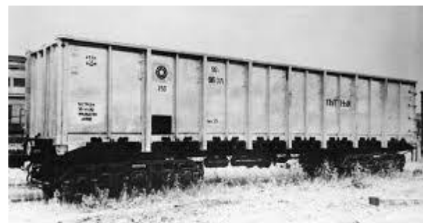
Рис. 7. Шестивісний напіввагон з кузовом, виготовленим із алюмінієвого сплаву [3]
