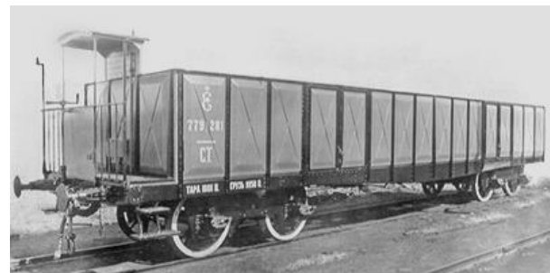
Рис. 3. Напіввагон системи Фокс-Арбеля [1]
