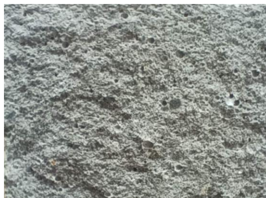
Рис. 3. Фото перерізів зразків із заміною 40 % піску (а) і 10 % цементу (б)
