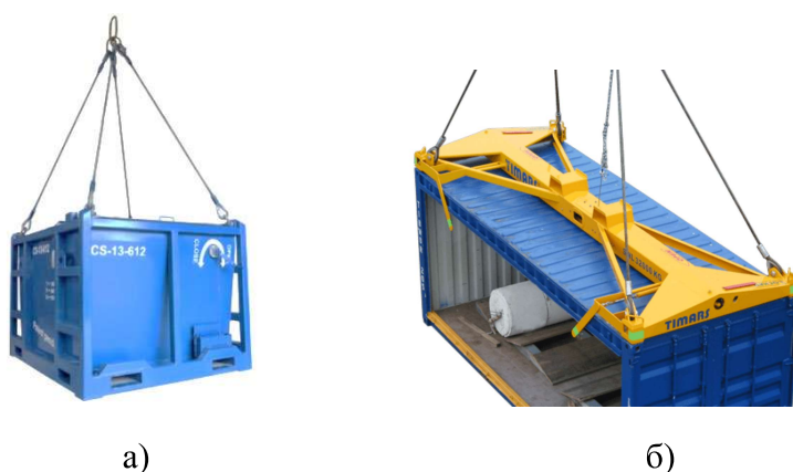
Рис. 2. Підвісні засоби транспортування при взаємодії із контейнерами а) стропи; б) спредер
