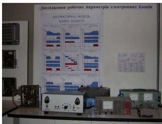
Рис. 4. Контрольно-діагностичне обладнання для електронного обладнання пасажирських вагонів
