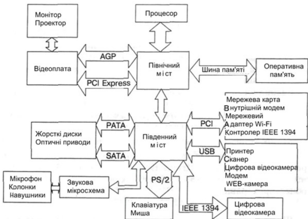
Рисунок 6 – Логічна схема системної плати
