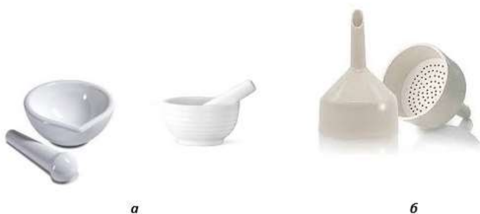
а – ступки з товкачками; б – лійки Бюхнера
