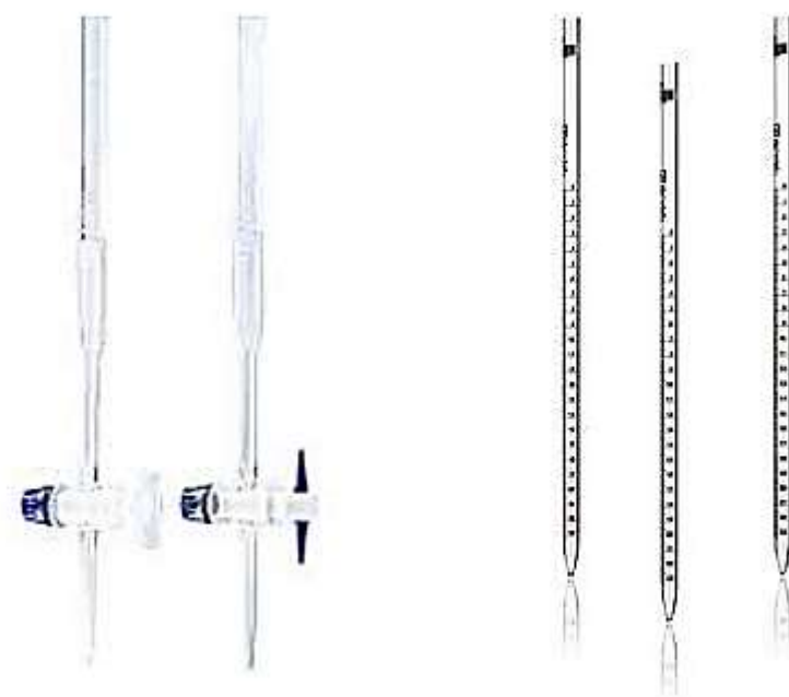
Рисунок 3.1 – Бюретки для титрування
