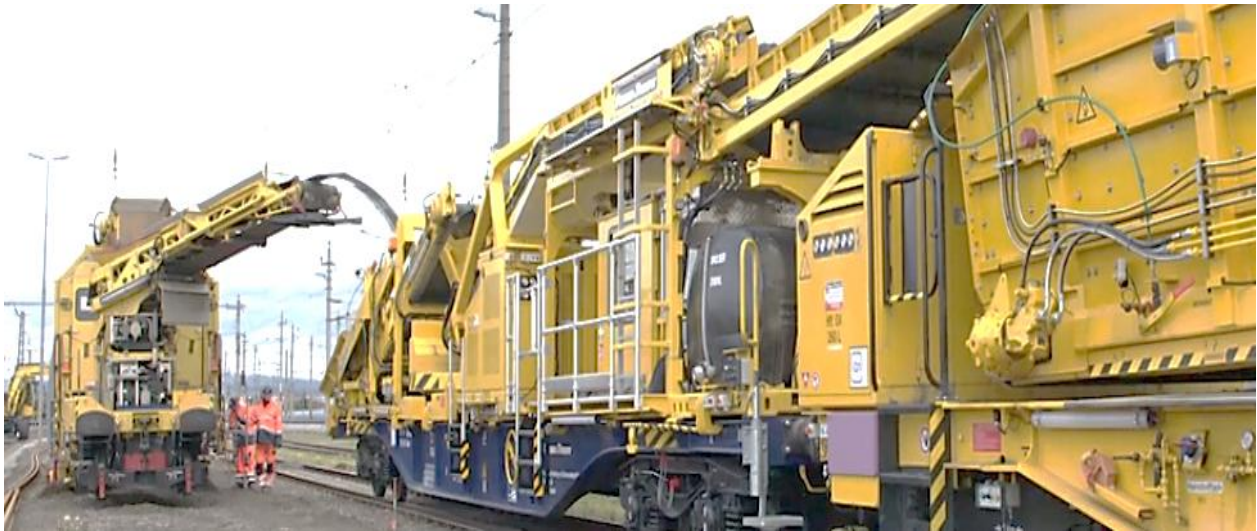
Рис. 5.20. Процес перевантаження вирізаного баласту до вагонів MFS
