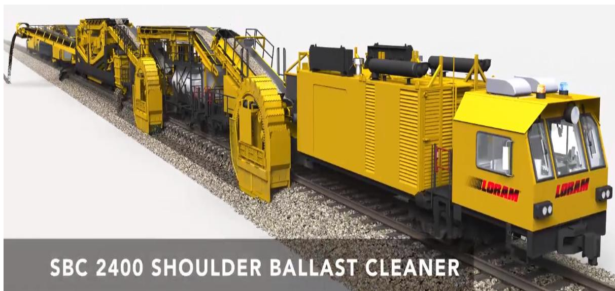
Рис. 3.12. Машина серії Loram Shoulder Ballast Cleaning SBC2400
