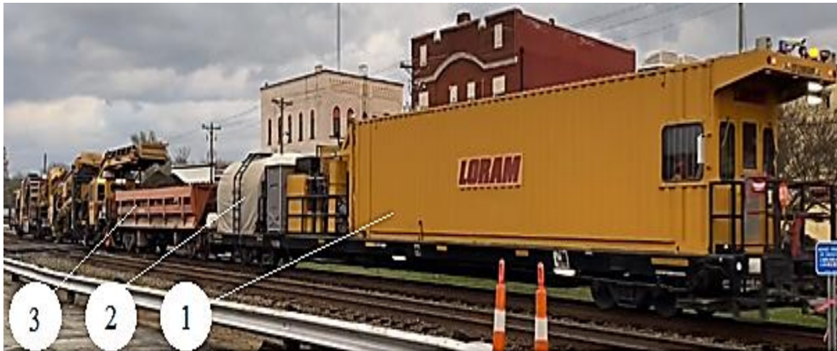
Рис. 3.11. Машина серії Loram HP SBC-35 (третя платформа): 1 - господарське приміщення і кабіна; 2 - цистерна з водою; 3 – напіввагон
