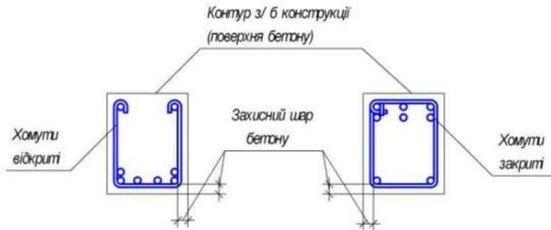
Рисунок 2 – Схема розташування арматури в бетонній суміші
