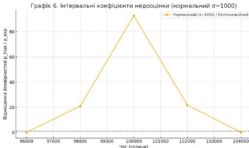
Рис. 6. Інтервальні коефіцієнти недооцінювання імовірностей небезпечних відмов (нормальний закон розподілу з параметром \sigma = 1000 )
