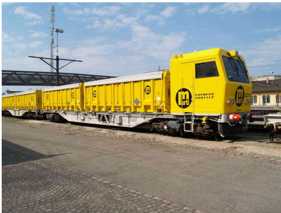
Рисунок 8.3 – Модульний контейнерний поїзд типу CargoSprinter розроблений фірмою Windhoff GmbH
