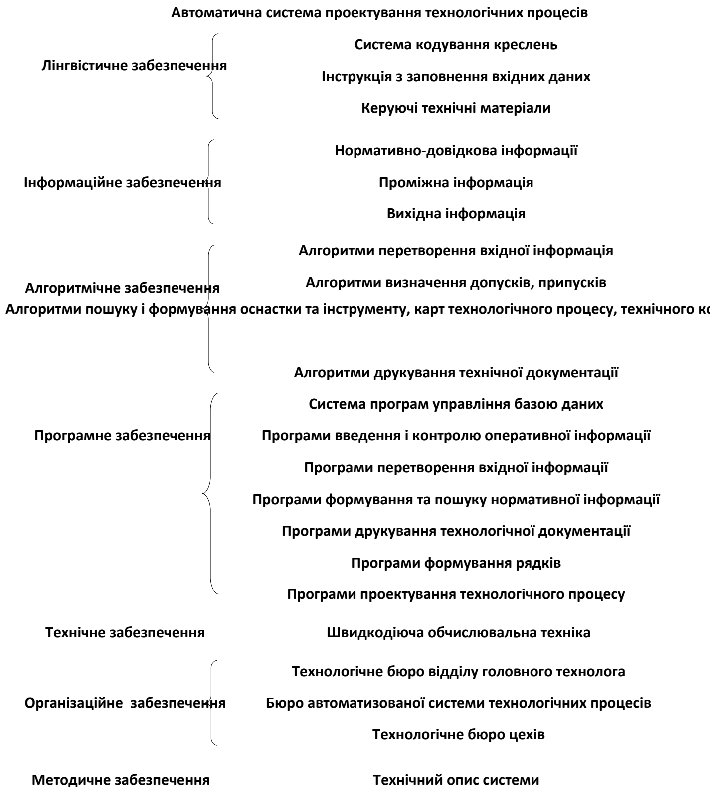
Рисунок 4.2 – Структурна модель САПР технологічних процесів
