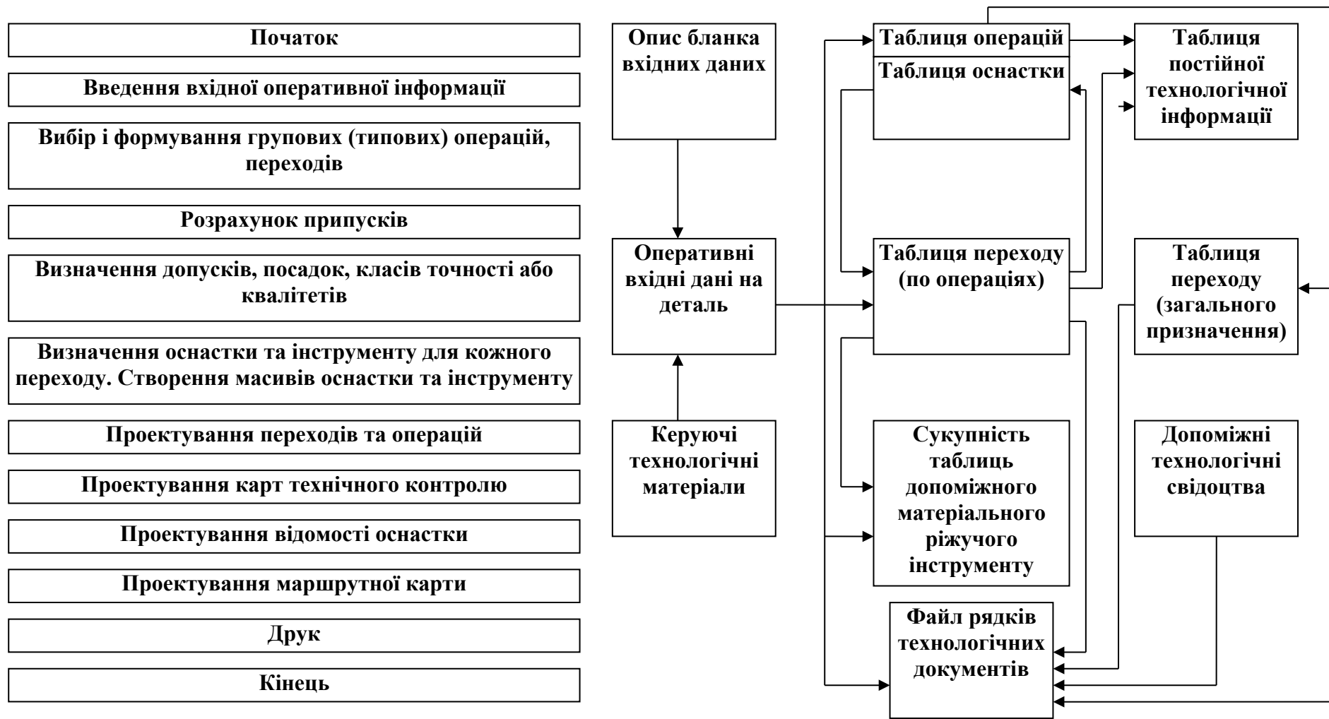
Рисунок 4.1 - Макросхема алгоритму САПР (ліворуч) і зовнішня організація даних САПР (праворуч) технологічних процесів
