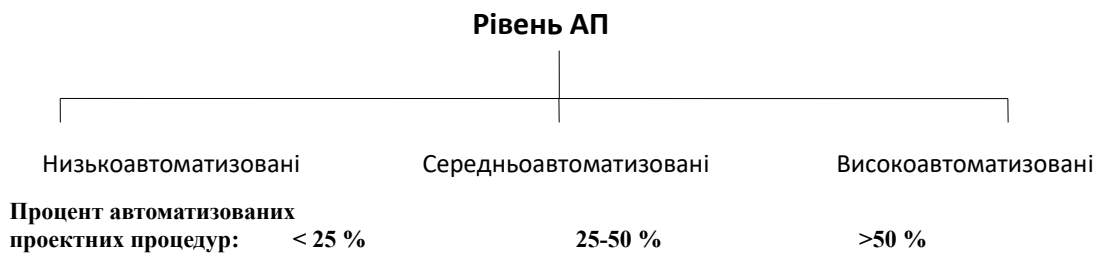
Рисунок 3.12 – Класифікація за рівнем автоматизації проектування
