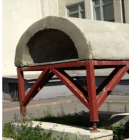
Рис. 12. Установлена циліндрична оболонка на каркас для випробувань
