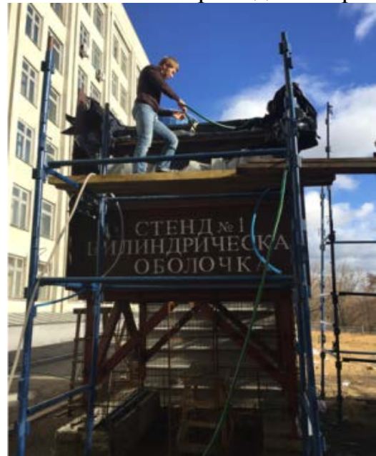
Рис. 14 Стенд для випробувань циліндричної оболонки
