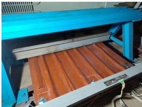
Рис. 7. Передача навантаження на кришку люка
