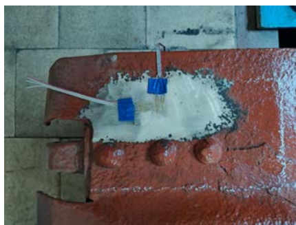
Рис. 2. Розміщення тензорезисторів на кришці люка
