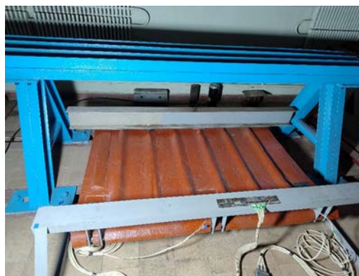
Рис. 5. Розміщення кришки люка на випробувальному стенді
