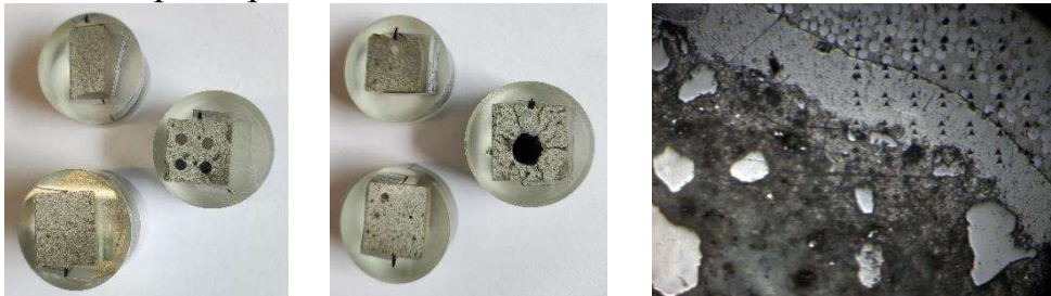
Рис. 3. Зразки зі сталеву дрютяною та композитною арматурою та електронно-мікроскопічний знімок зразка з композитною арматурою з відбитками нанодентера
