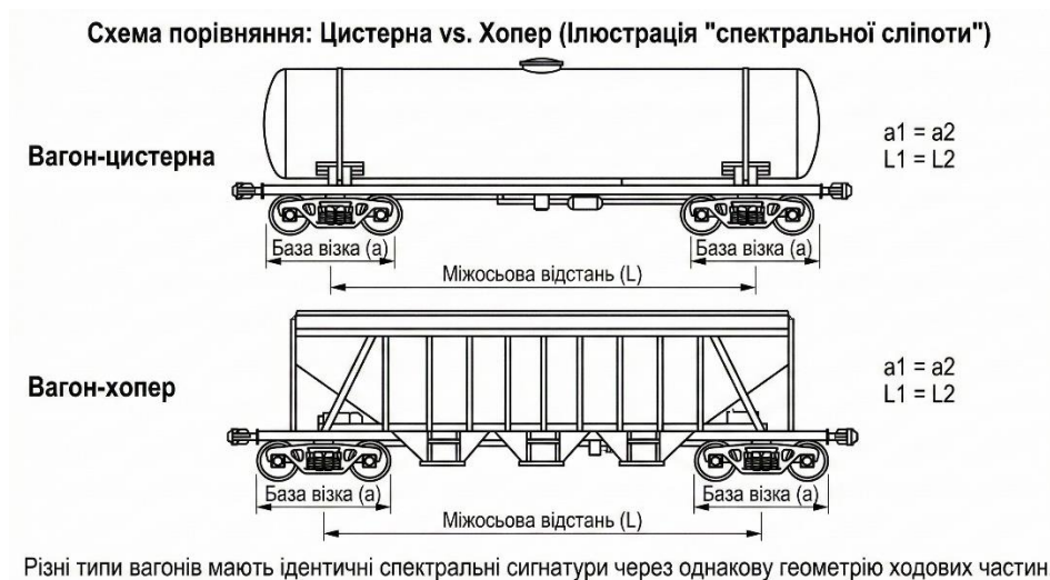
Рисунок 1.2 – Ілюстрація неоднозначності ідентифікації рухомого складу за статичними геометричними параметрами (кількістю та розташуванням вісей)
