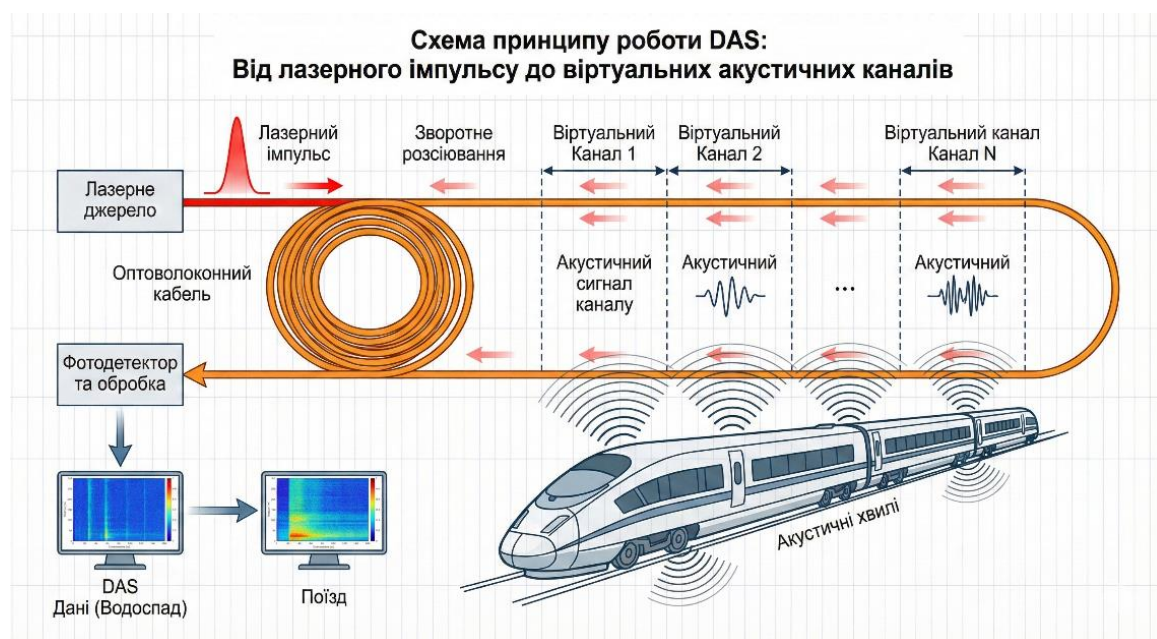
Рисунок 1.3 – Принцип роботи системи розподіленого акустичного моніторингу (DAS) на основі фазочутливої рефлектометрії
