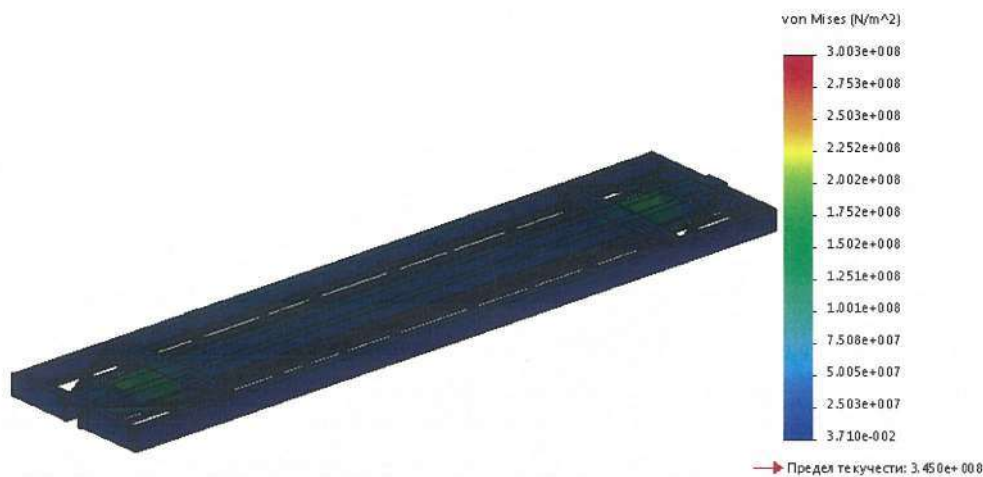
Рис. 6. Напружений стан несучої конструкції вагона-платформи
