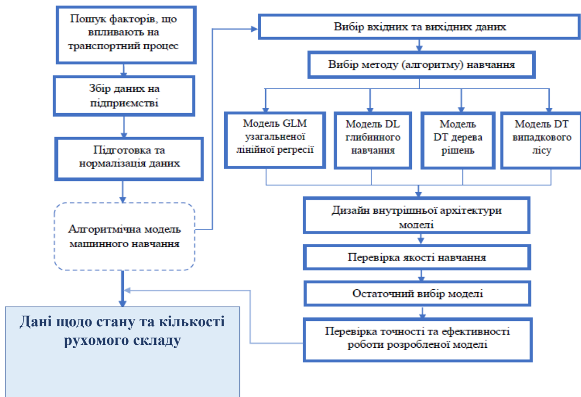
Рисунок 3.4 – Схема моделі автоматизації та оптимізації управління парком вантажних вагонів із застосуванням нейронних мереж
