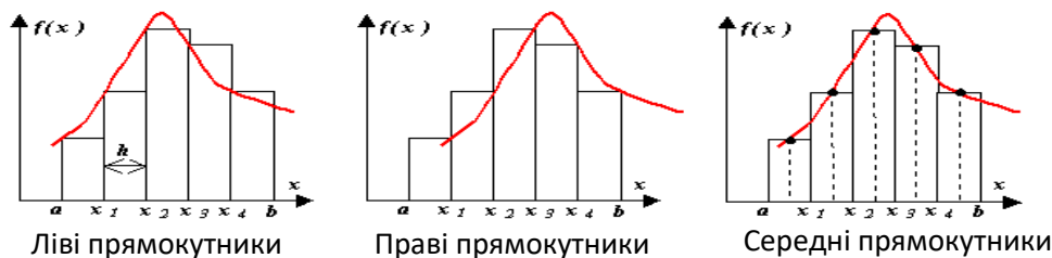
Рисунок 5.2 — Геометрична інтерпретація методів прямокутників
