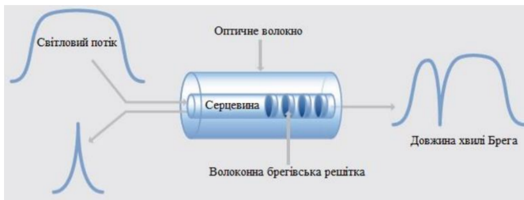
Рис. 1. Принцип роботи волоконного сенсора на основі решітки Брега
