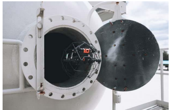
Рисунок 3.3 – Загальний вигляд контрольно-вимірювальних приладів для проведення телеінспекції
