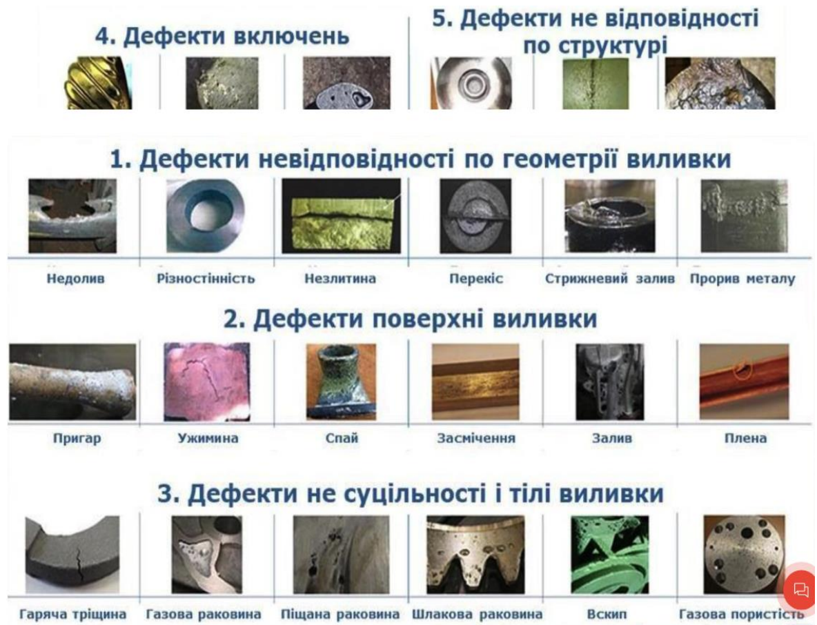
Рисунок 1.4 — Основні види поверхневих дефектів після відновлення
