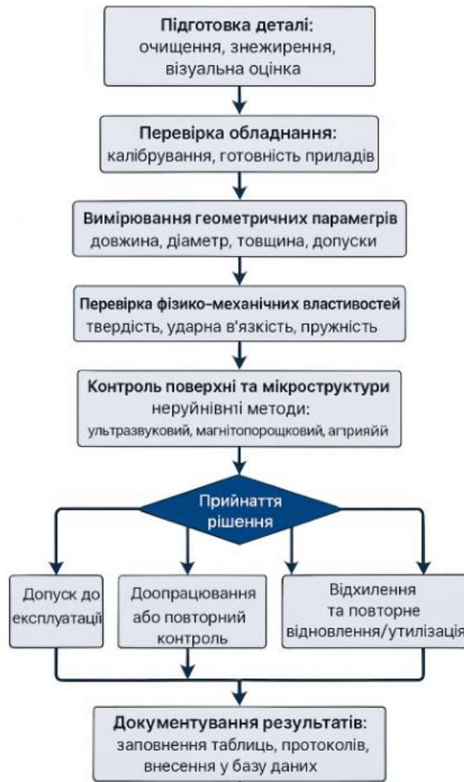
Рисунок 3.1 - Блок-схема алгоритму контролю відновлених деталей
