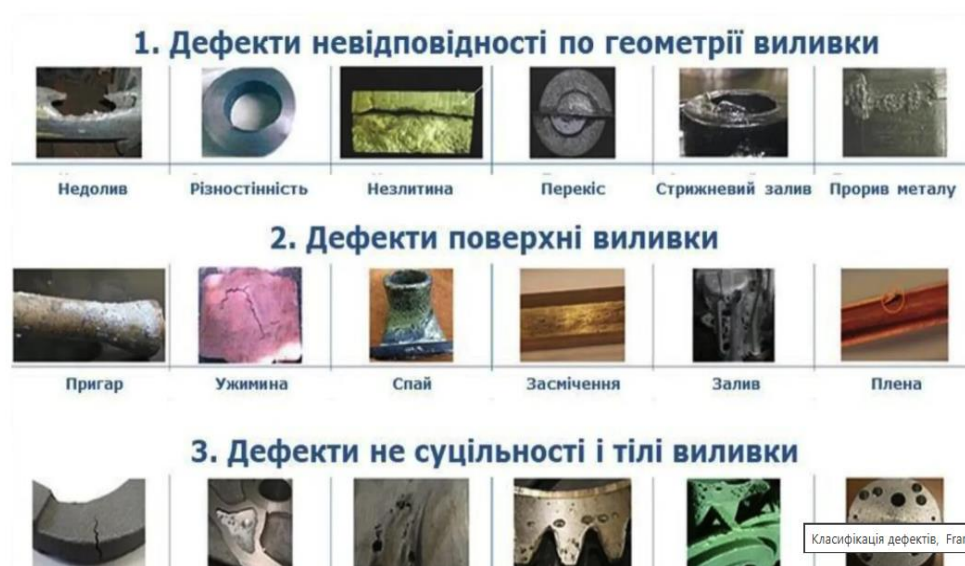
Рисунок 1.5 — Схема основних геометричних відхилень та дефекти поверхні і суцільності
