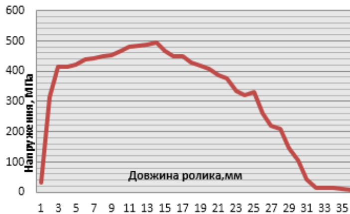
Рис. 4. Розподілення максимальних контактних напружень уздовж твірної ролика переднього підшипника
