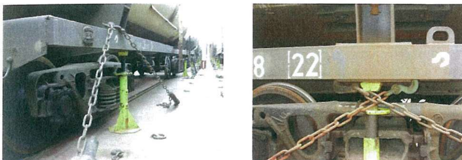
Рис. 9. Закріплення вагону-цистерни відносно палуби поромного судна
