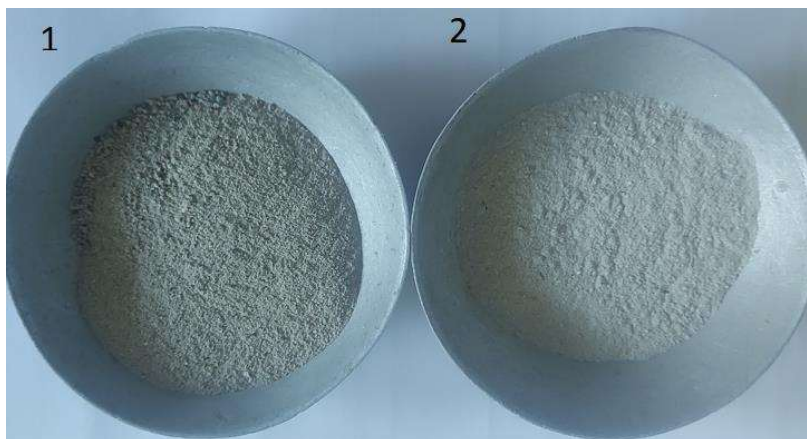
Рис. 1 Загальний вигляд добавок: 1 – зола, що утворилась на поверхнях теплообмінника котельного агрегату просіяна на ситі з розміром отворів 1 мм; 2 – зола із очисних циклонів
