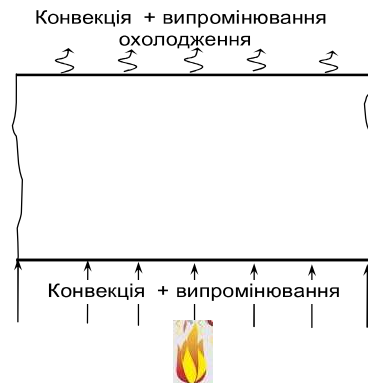
Рис. 1 Розрахункова схема до теплового розрахунку залізобетонних плит.
