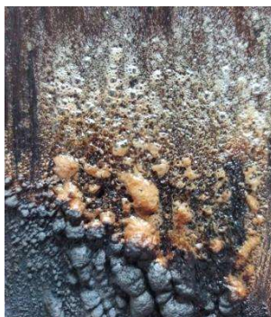
Рис. 1. Результати утворення захисного шару коксу при дії полум'я на вогнезахисний зразок термічно модифікованої деревини.
