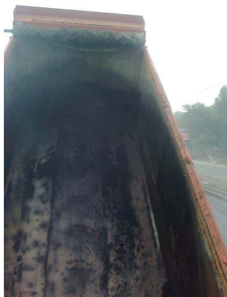
Рис. 3. Неякісне очищення від сторонніх матеріалів та предметів кузовів автосамоскидів
