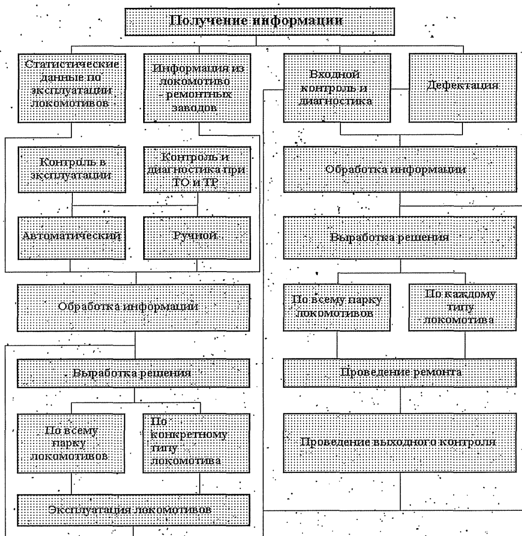
Рис. 1.7. Общая структура проведения контроля технического состояния локомотивов
