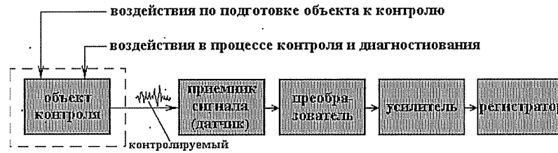
Рис. 1.4. Структурная схема преобразования сигнала
