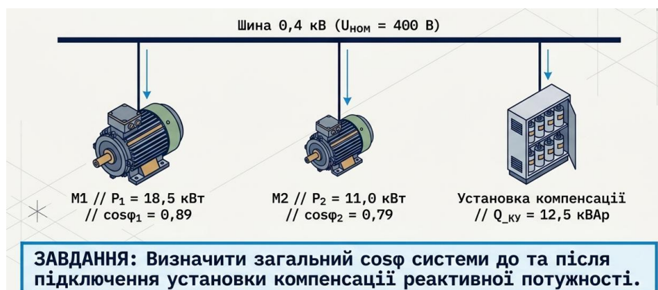
Рисунок 3.1.1 – Схема підключення двигунів
