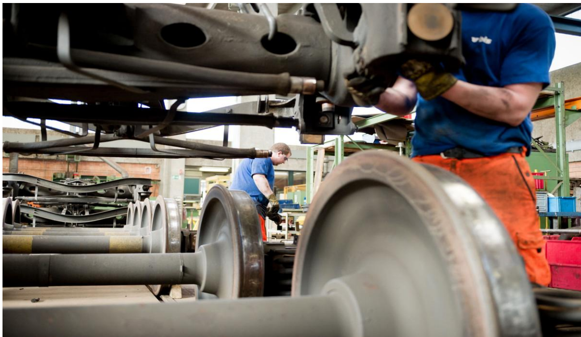
Рис. 1.8. Загальний вигляд спеціалізованої майстерні з ремонту ходових частин вагонів
