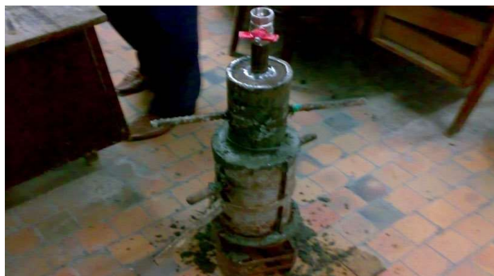
Рис. 1. Лабораторная установка для изготовления бетонных и железобетонных труб способом вибровакуумирования
