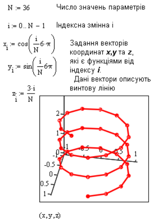
Рис. 1.55. Побудова гвинтової кривої
