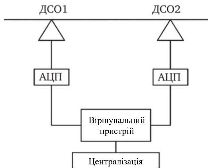
Рис. 13.1. Схема визначення зайнятості ділянки за допомогою датчиків лічення осей: ДСО – датчик лічення осей; АЦП – аналогово-цифровий перетворювач
