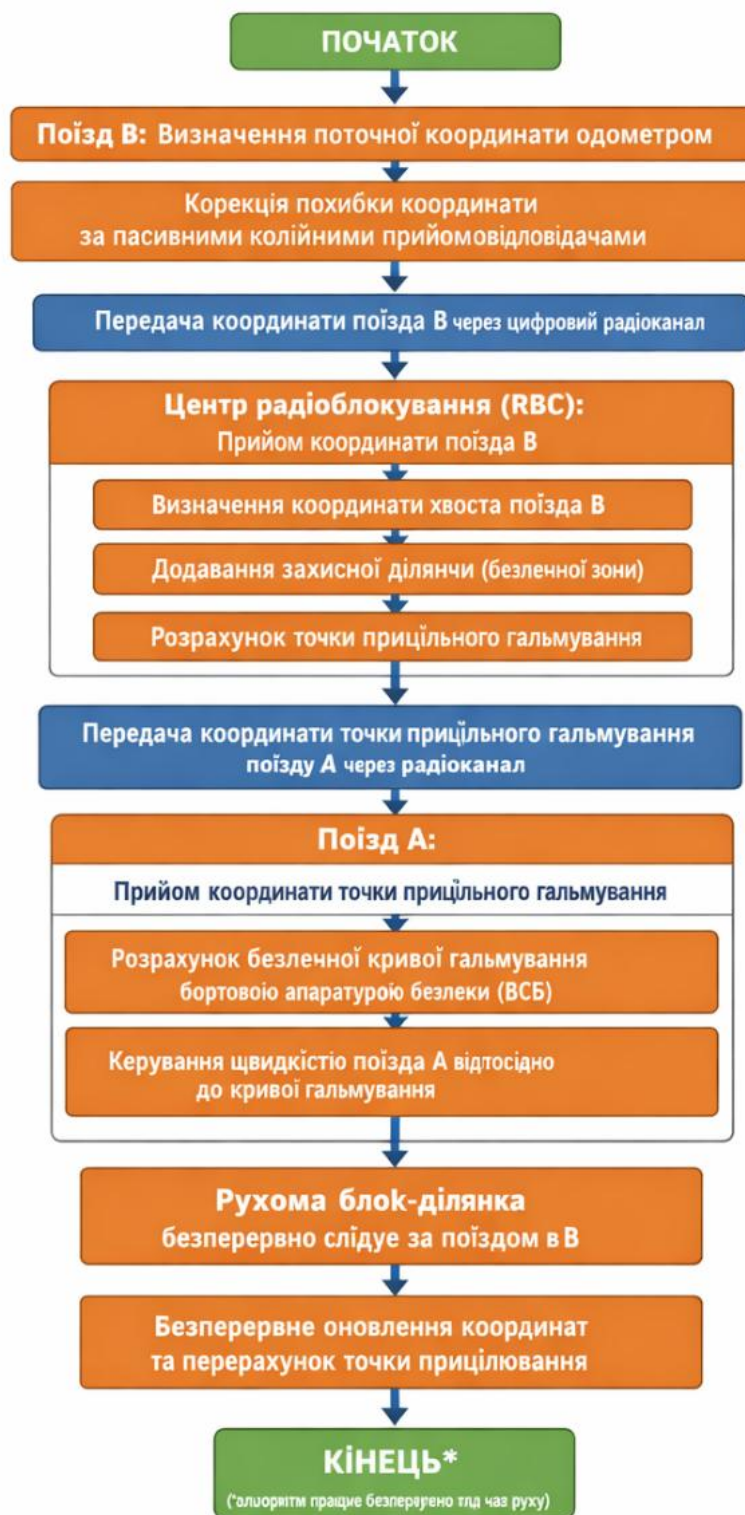
Рис. 1.1. Блок-схема взаємодії поїздів у системі з рухомими блок-ділянками: поїзд В рухається попереду; поїзд А рухається слідом; центр радіоблокування (RBC) – обчислювальний центр; цифровий радіоканал – засіб зв’язку
