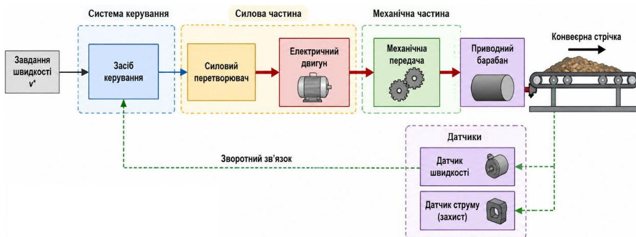
Рисунок 2.2 – Функціональна схема мехатронної системи конвеєрної установки
