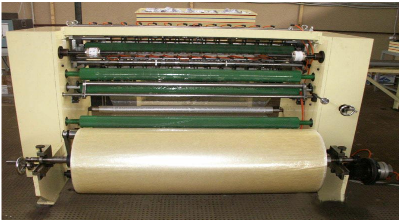
Рисунок 3.2 - Лінія для виробництва стрейч плівки модель РОЗ - 1000ТС
