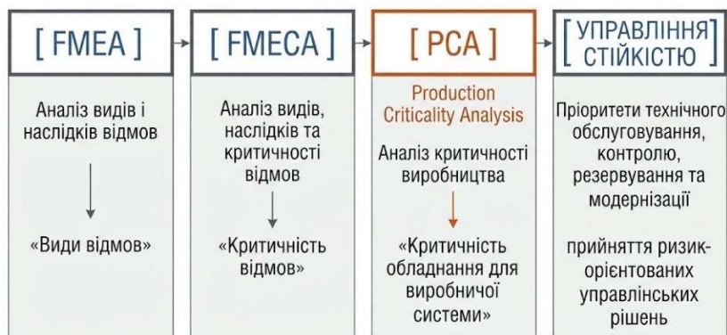
Рис. 1 – Логіка переходу від аналізу відмов до оцінювання системної критичності
