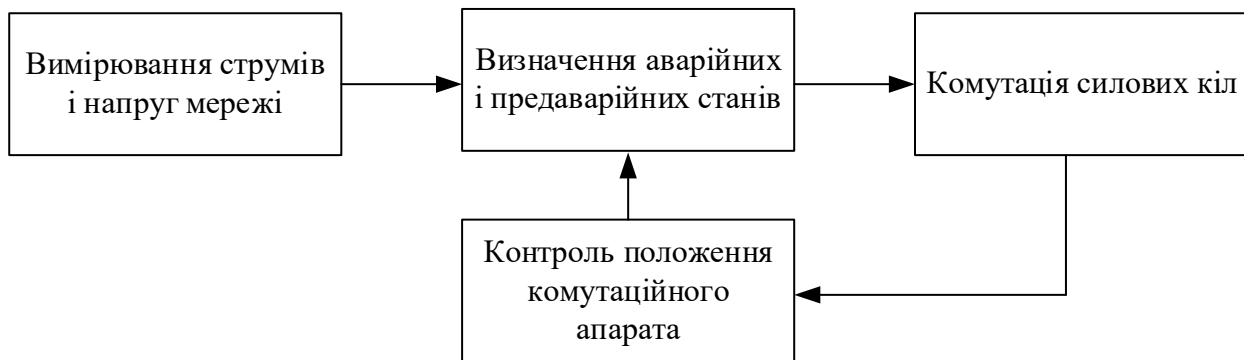
Рисунок 1.1 — Функціональна структура автоматики електропостачання
