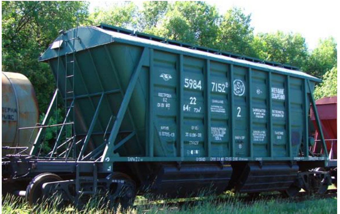
Рисунок 2.13 – 4-вісний вагон-хопер, модель 11-740
