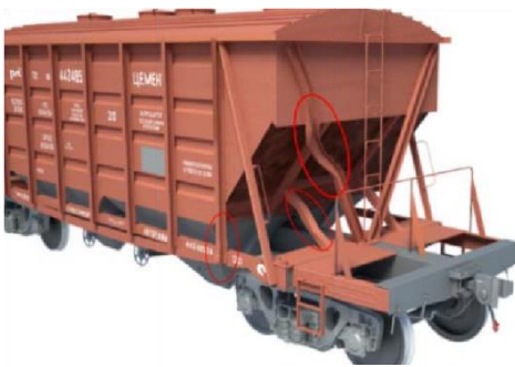
в) Погнуті і пошкоджені стійки і розкоси
