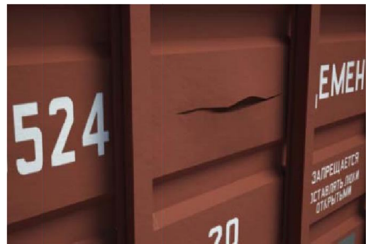
б) Пошкодження обшивки
