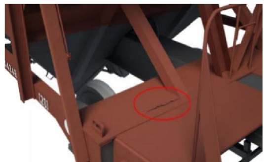
е) Поздовжні тріщини в балках рами
