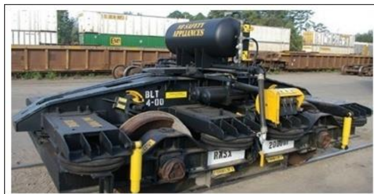
Рисунок 2.11 – Проміжний візок «RailRunner»
