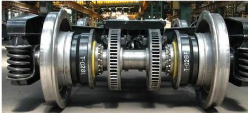
Рисунок 2.3 - Розсувна колісна пара SUW 2000 [9]
