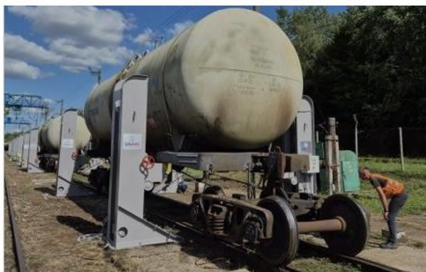
Рисунок 2.2 - Пункт перестановки вантажних вагонів на станції [8]
