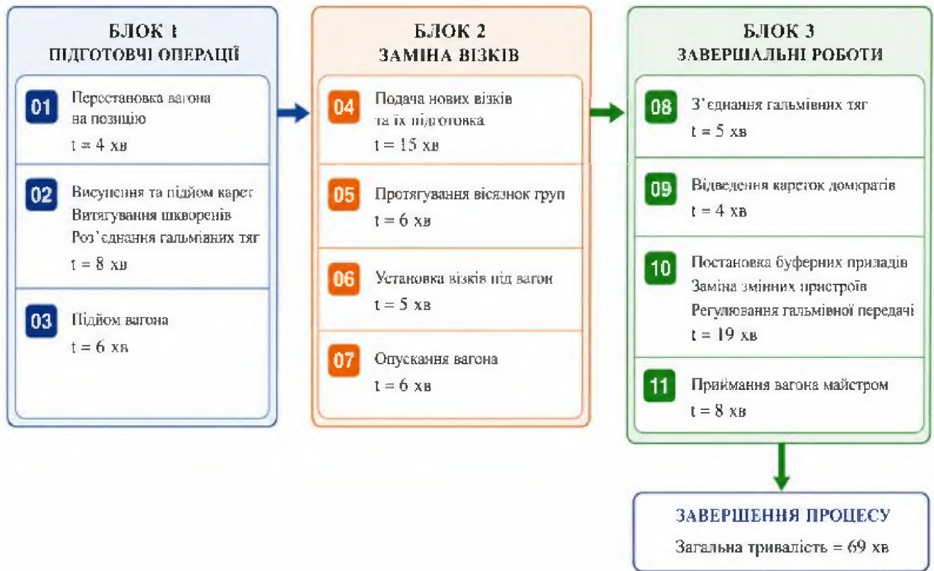
Рисунок 4.2 – Схема заміни візків вантажних вагонів (для групи вагонів)
