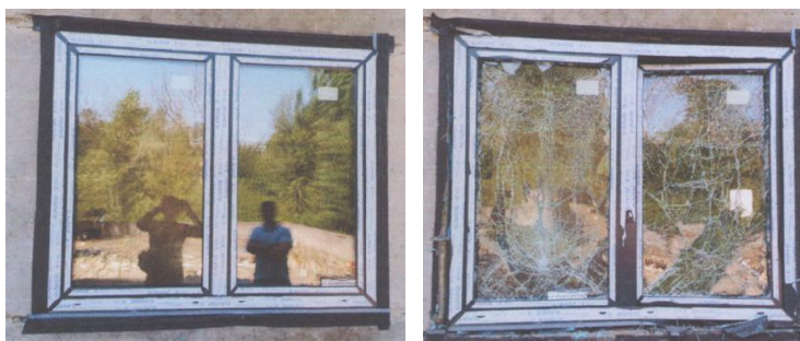
Рис. 4. Віконна конструкція зразка № S4-02_2024: до (ліворуч) і після (праворуч) випробування [18]
