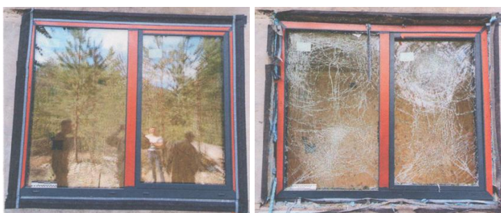
Рис. 2. Віконна конструкція зразка № S3-01_2023: до (ліворуч) і після (праворуч) випробування [17]
