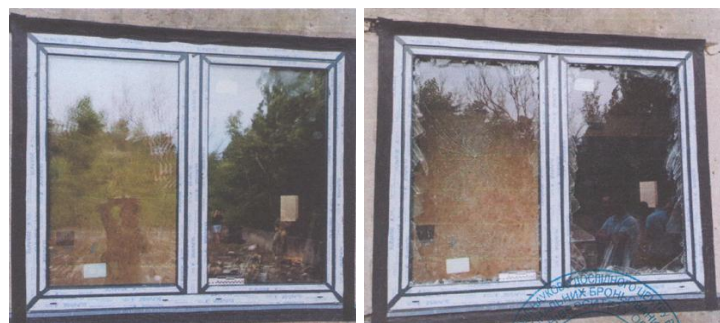
Рис. 6. Віконна конструкція зразка № S4-04_2024: до (ліворуч) і після (праворуч) випробування [18]
