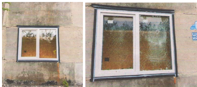
Рис. 1. Віконна конструкція зразка № S2-02_2023: до (ліворуч) і після (праворуч) випробування [19]
