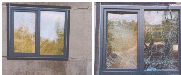
Рис. 5. Віконна конструкція зразка № S4-03_2024: до (ліворуч) і після (праворуч) випробування [18]
