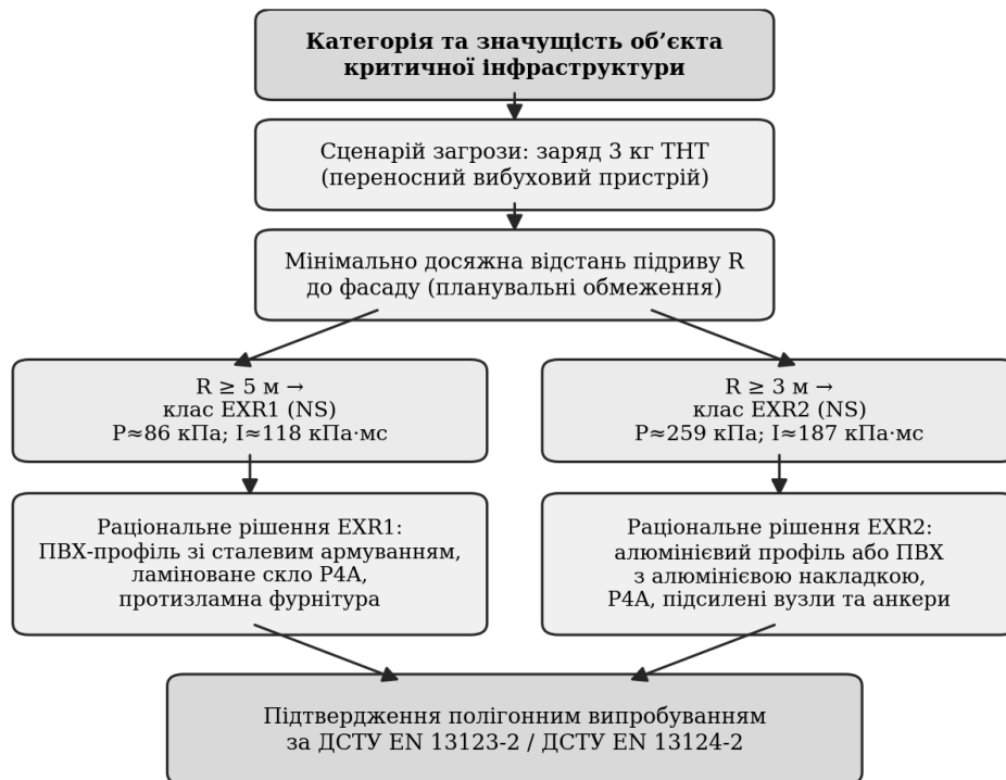
Рис. 8. Алгоритм вибору раціонального конструктивного рішення СОК за класом вибухостійкості
