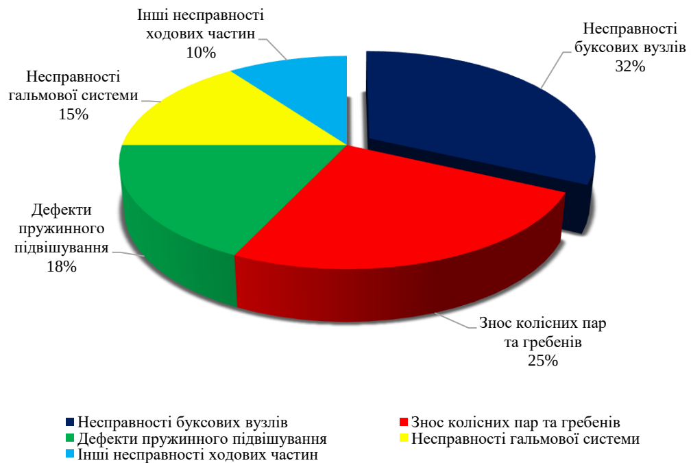
Рисунок 1.4 - Розподіл несправностей ходових частин пасажирських вагонів за типами
