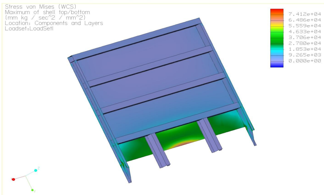
Рисунок 4.4 – Максимальні еквівалентні напруження (кПа) в торцевій стіні (стиснення -2,5 МН).
