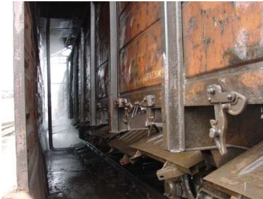
Рисунок 3.2 – Установка для обмивання вагонів
