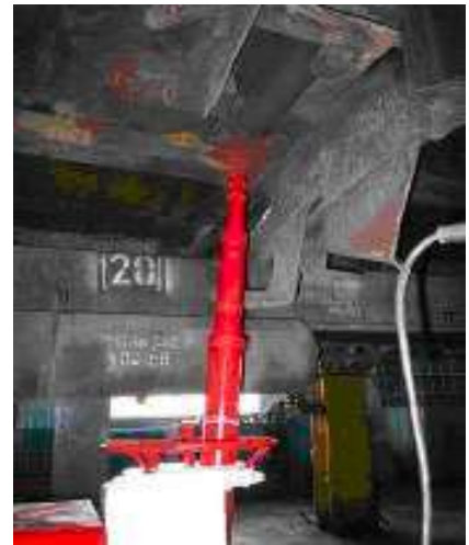
Рисунок 5.2 – Процес правки люків напіввагона
