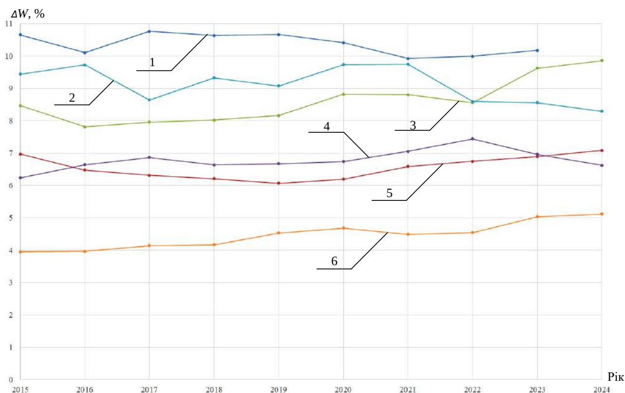
Рис. 5. Графік залежності втрат електроенергії під час передавання та розподілу (% обсягу виробництва) мереж зовнішнього електропостачання основних країн Європи за спожитою потужністю в період 2015-2024 рр.:
