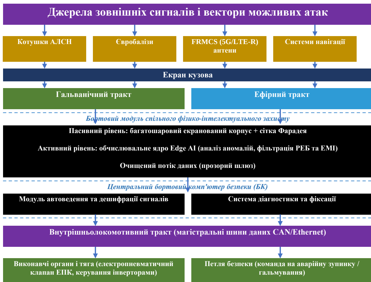
Рис. Структурна схема інтеграції бортового модуля в загальну бортову мережу рухомого складу
